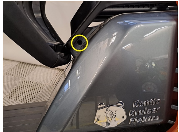
Irrota istuimen alapuoleista katetta pitävä ruuvi. (ristipäämeisseli ph2).
